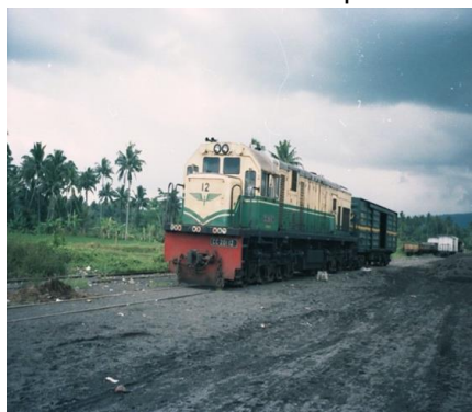
Gambar 2: Lokomotif CC 201 Dan perbedaan Gerbong Pengangkut Pasir tipe YYW dan YW
